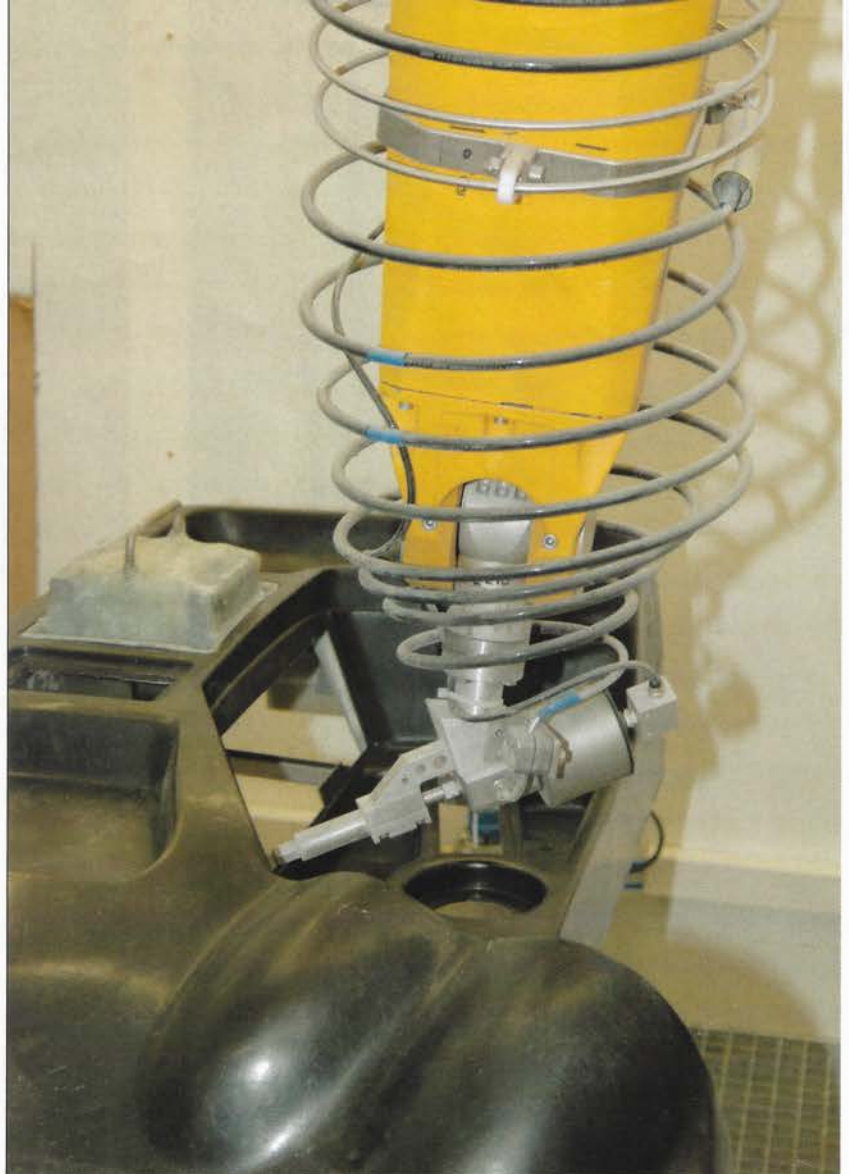
Jede Menge Schneidarbeit am Cockpit einer Pistenraupe: Dafür muss der Roboter sehr beweglich sein.
