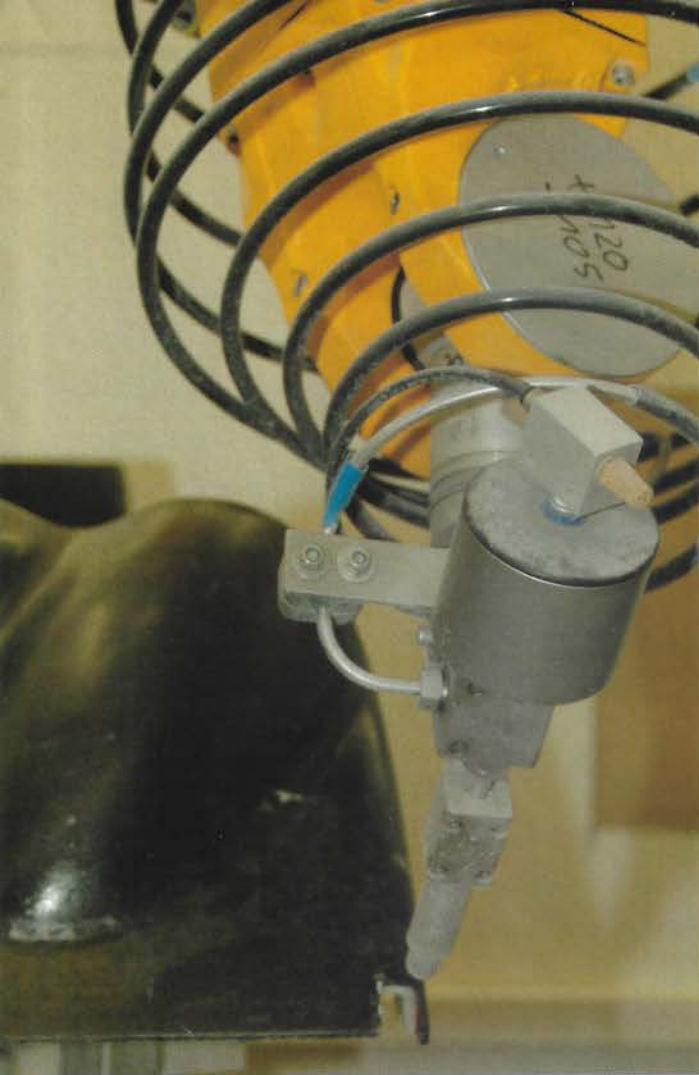
Mit dreifacher Schallgeschwindigkeit schießt das Wasser aus dem Schneidkopf. Bilder: A&Q
