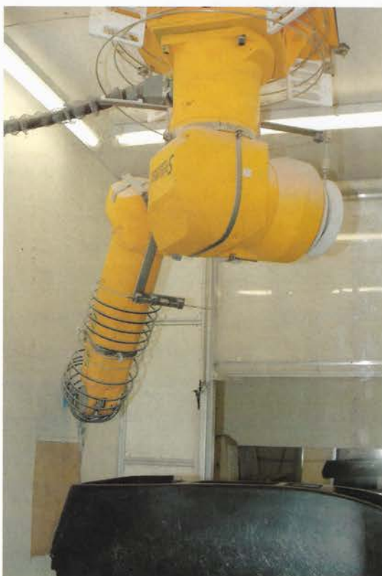
Unter dem hängenden Stäubli RX 130 ist die Arbeitsfläche in der Zelle frei, so dass große Werkstücke zur Bearbeitung auch verfahren werden können.
