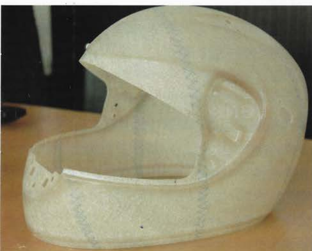
Fertig für die Montage: Dass Schnittkanten und Bohrungen ganz genau sitzen, dient auch der Sicherheit.
