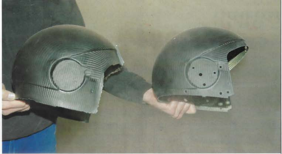
Noch hat sich der Wassernebel nicht verzogen, aber man sieht den Unterschied zwischen Rohling und fertig beschnittenem Helm.
